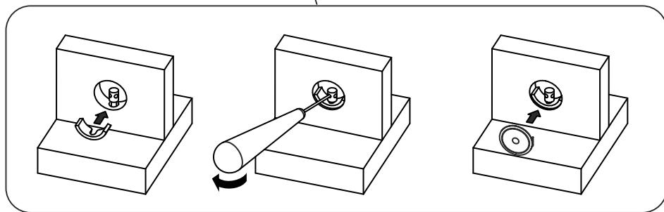
Порядок сборки сегментных стяжек: в отверстия царги вставить сегменты и с помощью шила завернуть винты до упора.
